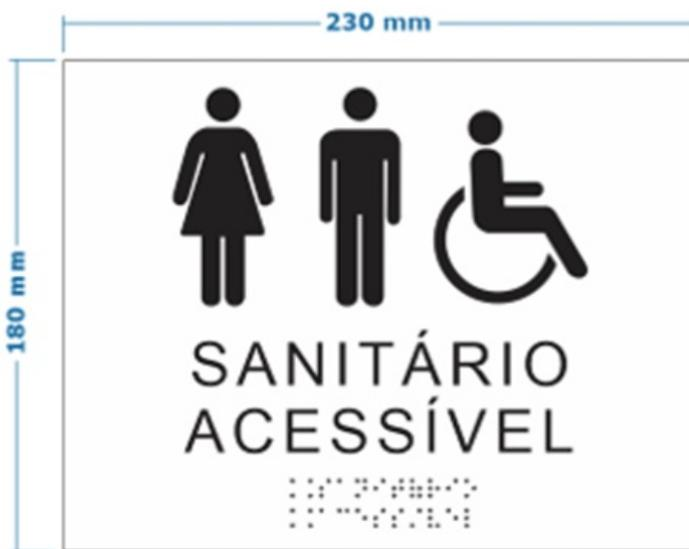
3.4.1.11. Placas de Comunicação Visual Específica – Sanitários – Tipo 4: placas de sinalização com inscrições em Braille e em alto relevo. Confeccionadas em material acrílico 3mm, na cor branco fosco (sem brilho). Inserção de pictogramas e letras em acrílico em alto relevo (entre 0,8 e 1,2mm – máximo 2mm), na cor preto. Dots (escrita Braille ou ponto em Braille) em alto-relevo (0,6mm, com diâmetro da base de 1,2mm), em material adequado e na cor preto.
