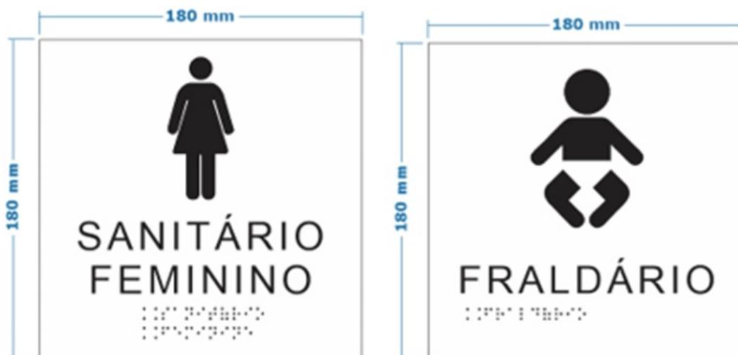
3.4.1.9. Placas de Comunicação Visual Específica – Sanitários – Tipo 2: placas de sinalização com inscrições em Braille e em alto relevo. Confeccionadas em material acrílico 3mm, na cor branco fosco (sem brilho). Inserção de pictogramas e letras em acrílico em alto relevo (entre 0,8 e 1,2mm – máximo 2mm), na cor preto. Dots (escrita Braille ou ponto em Braille) em alto-relevo (0,6mm, com diâmetro da base de 1,2mm), em material adequado e na cor preto.
