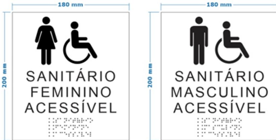
3.4.1.10. Placas de Comunicação Visual Específica – Sanitários – Tipo 3: placas de sinalização com inscrições em Braille e em alto relevo. Confeccionadas em material acrílico 3mm, na cor branco fosco (sem brilho). Inserção de pictogramas e letras em acrílico em alto relevo (entre 0,8 e 1,2mm – máximo 2mm), na cor preto. Dots (escrita Braille ou ponto em Braille) em alto-relevo (0,6mm, com diâmetro da base de 1,2mm), em material adequado e na cor preto.
