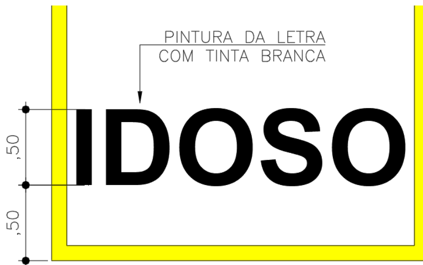
Figura 49 - Pintura para sinalização de Vaga de Idoso
